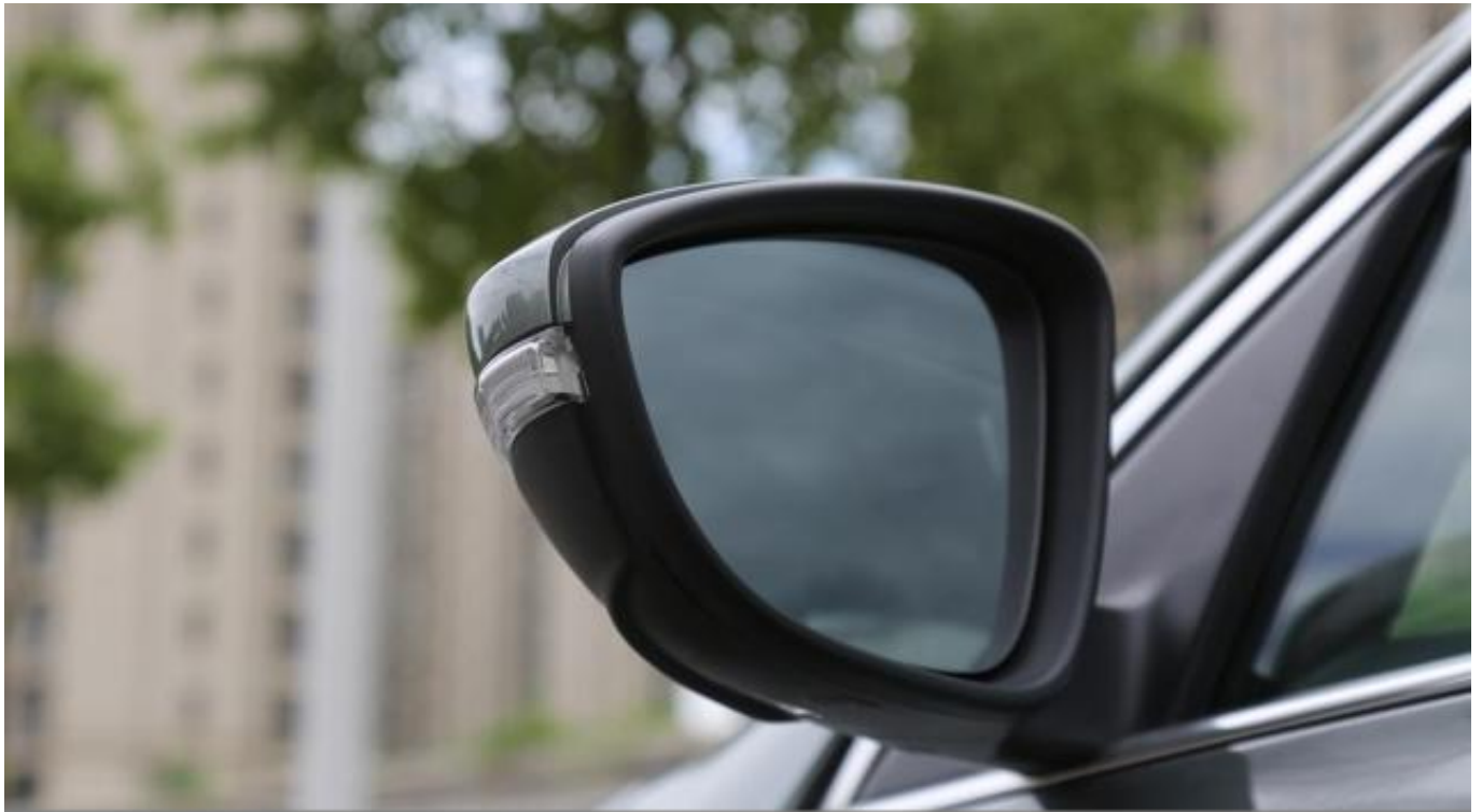
多功能外后视镜集成了电动调节、加热、转向灯、迎宾等功能
